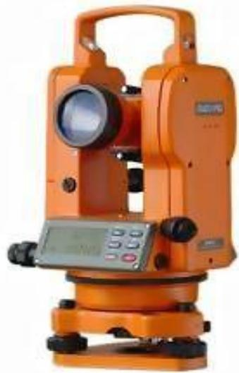
صورة رقم 08 : جهاز التيودوليت
